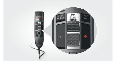
Bedienung per Schiebeschalter (schneller Vorlauf, Aufnahme/Wiedergabe, Stopp, schneller Rücklauf)
